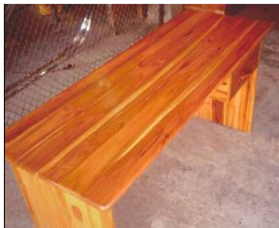
Figura 13. Una mesa construida de teca de entresacas de plantaciones jóvenes en Colombia
